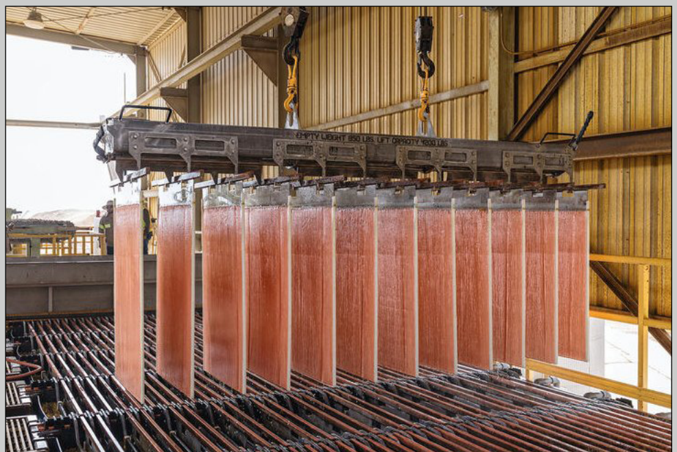
Abb. 4: Hochreine Kupferkathoden aus der Produktion der Johnson Camp Mine (Quelle: Gunnison Copper)
