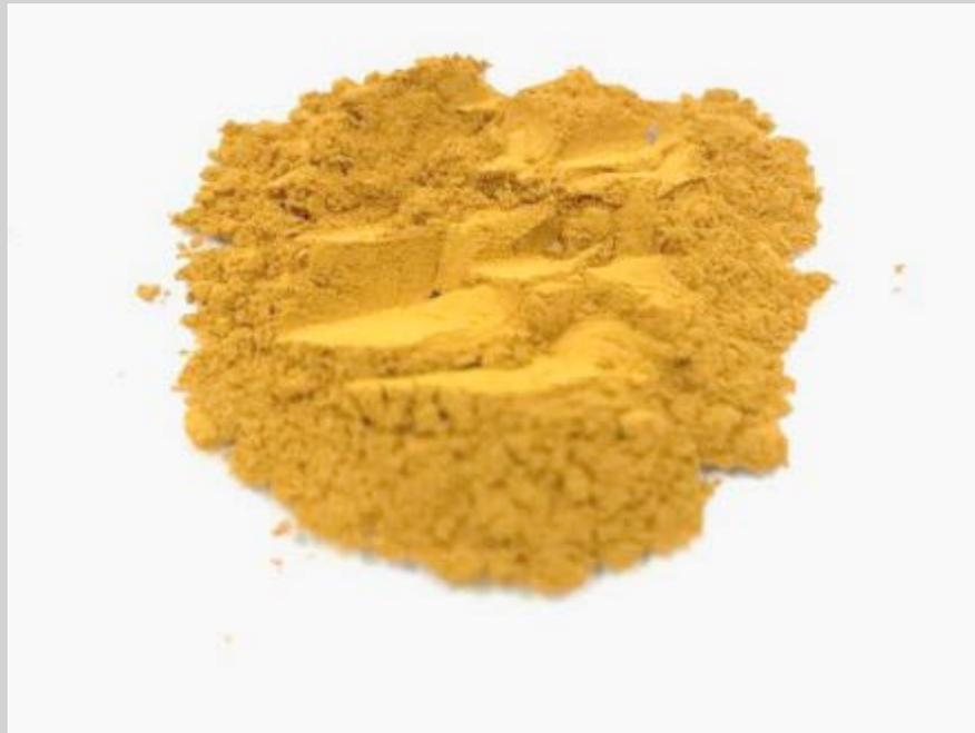
Abb.5: Foto vom hochreinen Endprodukt Vanadiumpentoxid (Quelle: Technology Metals Australia)
